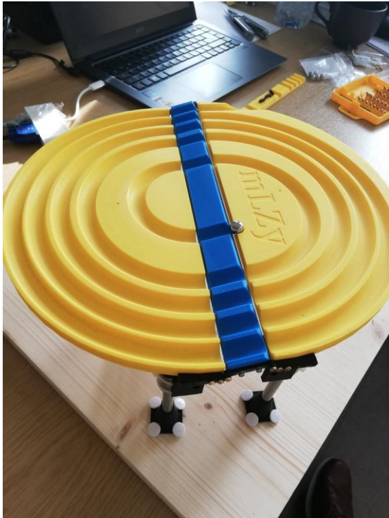
Abb.13: Foto, Modell des mechanischen Lehr-Zyklotrons (kurz: mLZy)
