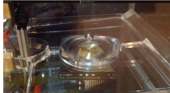
Abb.7: Nachbau des mechanischen Modells von Wolfgang Paul zum Potentialbild eines Quadrupols
