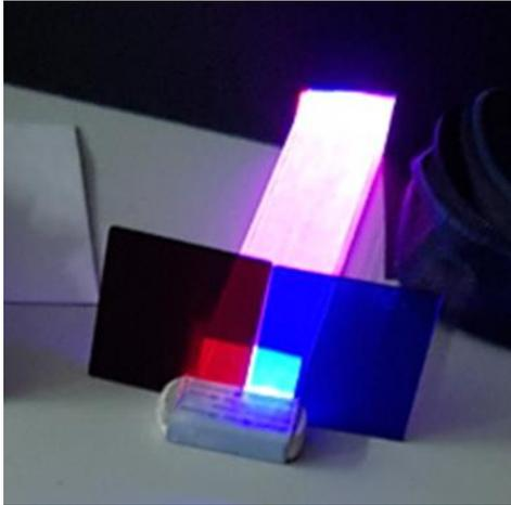
**Abb.9:** Lernende haben Farbfilter am Ende des Plexiglasquaders mit einem Radiergummi fixiert.
