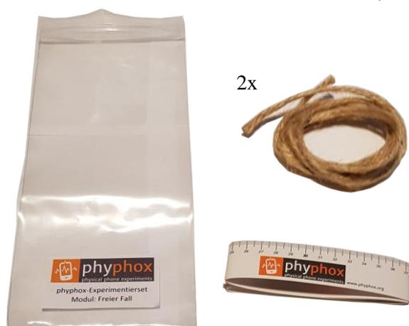
**Abb. 1:** Darstellung des Experimentiersets zum Versuch Fadenpendel. Im Experimentierset sind ein Druckverschlussbeutel, der gleichzeitig auch als Smartphone-Halterung dient, zwei Fäden mit einer Länge von einem Meter und in der Weiterentwicklung nach der Befragung der Studierenden auch ein Maßband enthalten.
