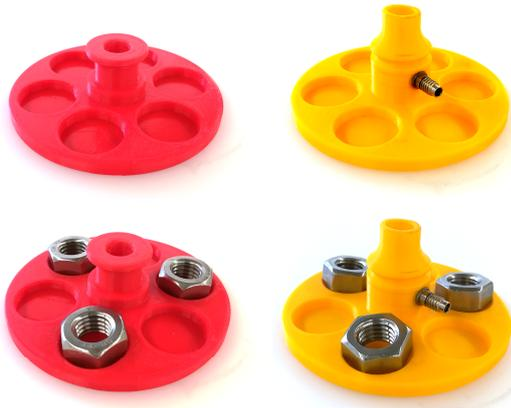
**Abb.2:** Verschiedene Bauformen der verwendeten Luftkissenscheiben. Links: Einfache Variante für Schülerexperimente. Rechts: Variante mit Fahrradventil.
