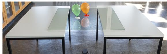
**Abb.3:** Versuchsaufbau mit Glasplatte zwischen zwei Tischplatten. Gefilmt wird von unten mit einem Smartphone.
