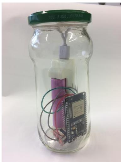
Abb.5: Ein ESP32 mit dem Sensormodul BME280 in einem Einmachglas zur Messung eines isochoren Prozesses.
