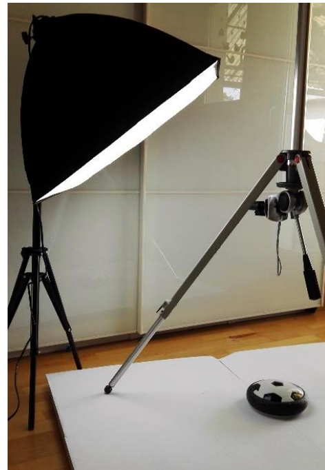
Abb. 6: Aufbau für die Videoanalyse der Bewegungen des Luftkissenpucks
