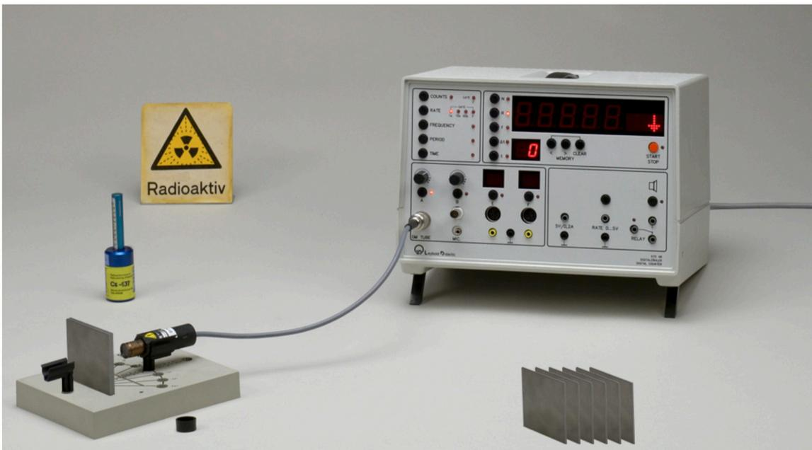
Abb. 4: IBE zur Lernaufgabe „Absorptionsgesetz für Gamma-Strahlung“.
