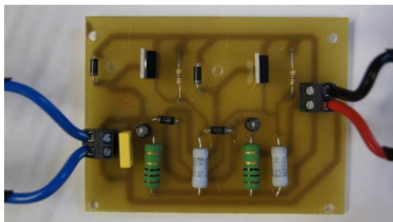
Abb. 2: Platine des Royer-Oszillators mit Anschlüssen für die Gleichspannungsquelle (schwarz-rot) und für die Senderspule (blau).
