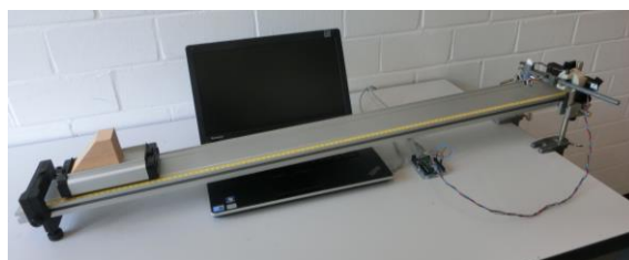
Abb.3: Aufbau zur Analyse der Bewegung eines Messwagens auf einer schiefen Ebene mit einem Ultraschallsensor
