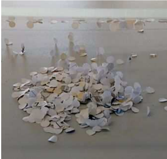
Abb. 6 Elektrostatische Anziehung von Papierstücken durch eine Plexiglasscheibe.
