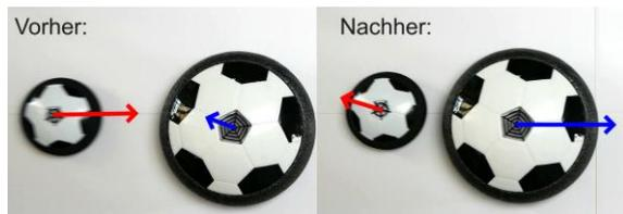
**Abb. 14:** Ein leichter Puck stößt auf einen schweren Puck mit eingezeichneten Impulsfeilen.
