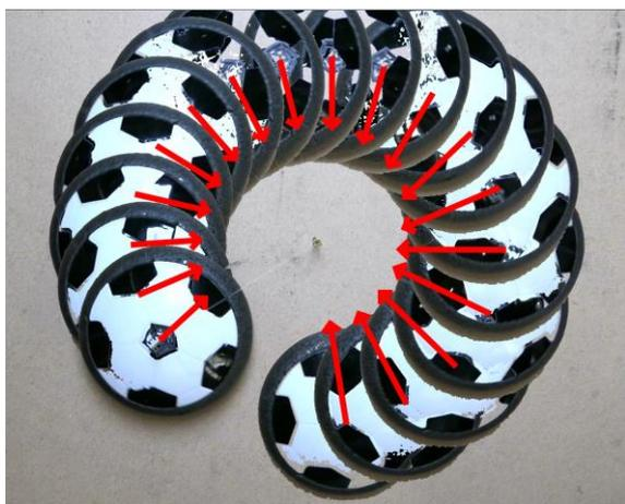
**Abb. 7:** Beschleunigung eines Luftkissenpucks bei einer Kreisbewegung
