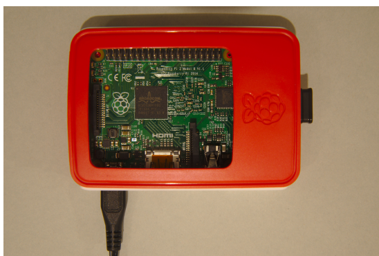
Abb. 2: Raspberry Pi 2 Modell B mit WLAN-Adapter (rechts im Bild) und Netzteil sowie eingesetzt in ein Gehäuse.
