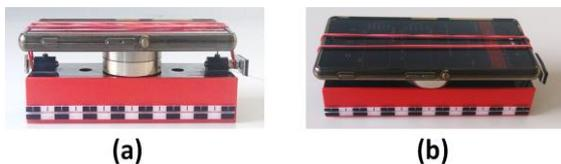
**Abbildung 4:** Aufbau des Wagens für das Smartphone-Experiment auf der Luftkissenfahrbahn aus zwei Perspektiven, (a) Bild von vorne, (b) Bild von schräg oben. Durch eine glatte Erhöhung wird das Smartphone vor Kratzern durch den Wagen geschützt. Die Befestigung des Smartphones erfolgt durch ein Gummiband, welches an den Fadenhaltern des Wagens befestigt wird.
