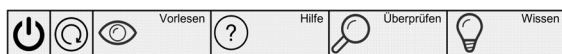
Abb.4: Bedienzeile der interaktiven Arbeitsblätter aus der Studie von [11]. Von links: Anschalten zur Zuordnung zwischen den einzelnen Arbeitsblättern und Programmen (.gme-Dateien), Wiederholung der vorherigen Audio-Ausgabe, Vorlese-Modus , Gestufte-Hilfen-Modus , Überprüfen-Modus , zusätzliche Expertenaufgabe .
