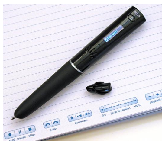
Abb.1: Smartpen und „Dot-Paper“ zur Aufnahme von Audiosignalen und zur Digitalisierung von Schreibprozessen.
