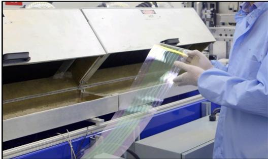
Abb. 2 Gedruckte organische Photovoltaik
