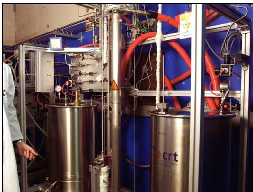
Abb. 3 Anlage zu Beladung flüssiger Wasserstoffträger
