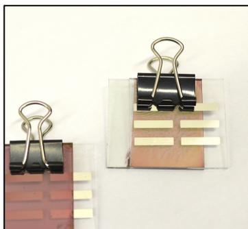
Abb. 5 Organische Solarzellen auf leitfähigen Glasträgern, beschichtet durch Spin-Coating
