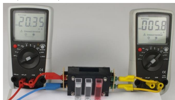
Abb. 5: Versuchsapparatur zur Messung der Absorption des eingestrahlt LED-Lichts mithilfe von Küvetten mit Farbstofflösung, LED und Fotodiode ([4]).
