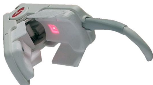
Abb. 3: Fingermessapparatur mit strahlender LED [8]
