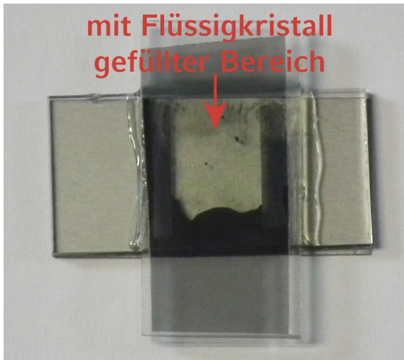
Abb. 3: Zu 80 % mit Flüssigkristall gefüllte Modellzelle
