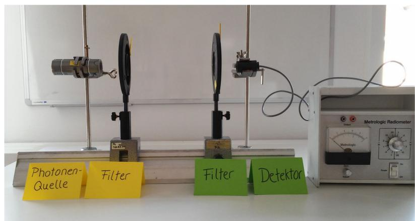
Die Ergebnisse müssen anschließend für ein einzelnes Photon interpretiert werden: Bei einem Winkel von  $45^\circ$  zwischen den Polarisationsrichtungen gelangt gerade in 50% der Fälle ein Photon, das durch den ersten Filter gekommen ist, auch durch den zweiten Filter.
