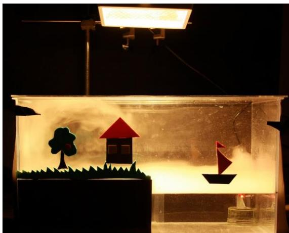
**Abb. 3** Typische Realisierung eines Modells zum Land-See-Wind.
