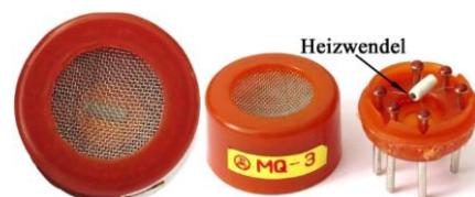
Abb. 1: Ethanol Gassensor MQ-3. Links ist der Sensor in der Draufsicht zu sehen. Das Röhren schimmert unter dem Gitter hervor. Rechts sieht man das Röhren und am linken Rand des Röhrens die Heizwendel.
