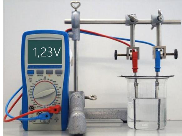
Abb.8: Modell einer reversiblen Brennstoffzelle
