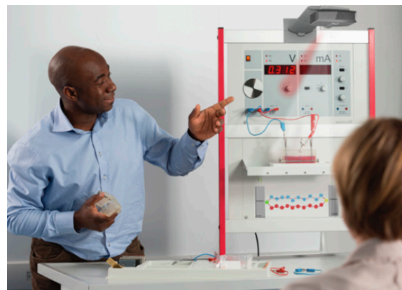
Abb. 1: Das reale Experiment im Praktikum wird simultan zum Experimentierprozess per Aufprojektion multimedial augmentiert. Neben der kontextbasierten tutoriellen Assistenz (Anleitung, Lenken der Aufmerksamkeit) gehören dazu auch parametergesteuerte Animationen, hier der Transport von Ionen in einem Elektrolyten bei verschiedenen Stromstärken. Quelle: LD Didactic, Montage AG Nordmeier.
