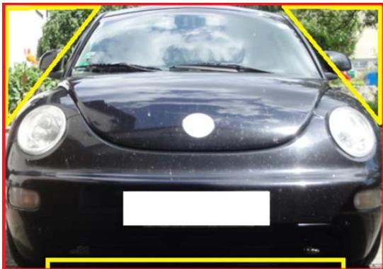
**Abb. 3:** Die wirksame Fläche entspricht der Differenz aus der rot und der gelb markierten Fläche, welche mittels Zeichenprogramm ermittelt wurde.
