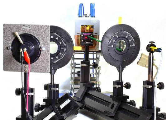
**Abb.5:** Foto des Schulaufbaus zur Messung des polaren magnetooptischen Kerr-Effekts.
