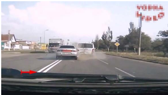
Abb. 8: Zur Feststellung einer Änderung der Bewegungsrichtung wurde der Punkt beobachtet (Spitze des roten Pfeils), an dem sich die Fahrbahnmarkierung und der Scheibenwischer schneiden.
