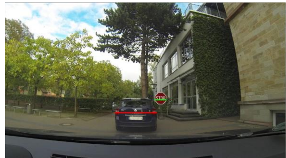
Abb. 4: Messung des Abstandes zum stehenden Auto und zum Stoppschild über deren Pixelgröße im Video
