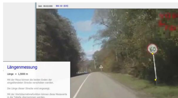
Abb. 14: Bestimmung des Länge des ersten Rohrpfostens, wobei die Breite des Schildes zur Skalierung verwendet wurde.
