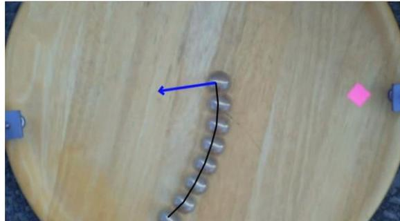
**Abb. 8:** Bild aus einem Stroboskopvideo einer Kugel, die gerade über einen Drehteller rollt, wobei die Kamera sich mit dem Drehteller dreht
