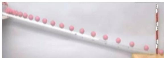
**Abb. 1:** Bild aus einem Stroboskopvideo zu einer gleichmäßig beschleunigten linearen Bewegung auf der schiefen Ebene.
