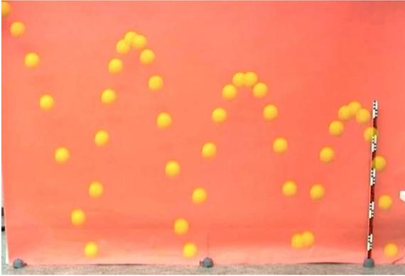
**Abb. 2:** Bild aus einem Stroboskopvideo eines hüpfenden Gummiballs
