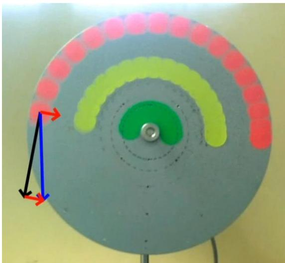
**Abb. 7:** Bild aus einem Stroboskopvideo einer rotierenden Kreisscheibe mit den eingblendeten Pfeilen  $v$ ,  $v_{alt}$  und  $\Delta v$
