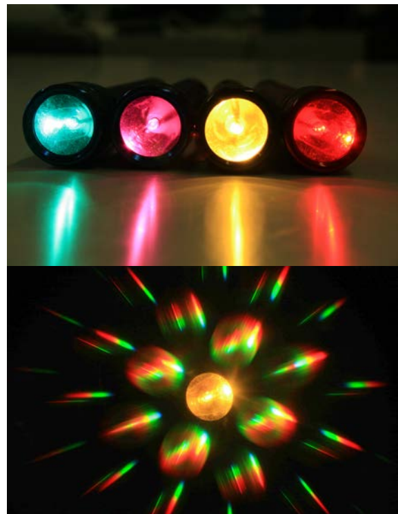
Abb. 6: Taschenlampen mit farbigen Kunststofffolien (oben) und Blick durch die Farbenbrille auf die gelbe Lampe (unten). In der Mitte ist hier in 0. Beugungsordnung die gelb leuchtende Taschenlampe sichtbar.
