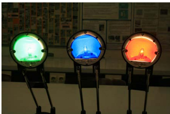
Abb.7: Als Lichtquellen für die additive Farbmischung eignen sich preiswerte Schreibtischlampen mit Kunststofffolien in grün, blau und rot.
