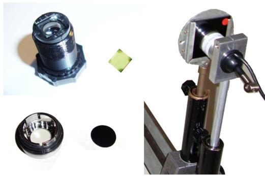
Einsatz einer Webcam. Oben links: rückseitige Ansicht auf das Objektiv der Webcam (Fa. Conrad) mit dem entfernten IR-Sperrfilter. Unten links: Objektivring mit danebenliegendem Diapositiv als IR-Durchlassfilter. Rechts: Alternativ kann ein Filterhalter 50 x 50 mm<sup>2</sup> für Diarahmen benutzt werden.
