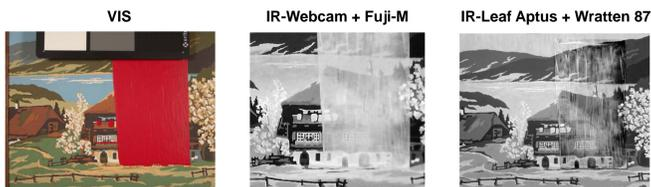
Links: Ursprungsbild wurde mit Acryl-Zinnoberrot übermalt und mit Glühlampen, 2 x 60 W, frontal und mit dem IR-Sperrfilter der Sony Kamera aufgenommen. Mitte: Aufnahme Webcam, 8 MPx, ohne internen IR-Sperrfilter, mit IR-Durchlassfilter „Fuji-M“. Rechts: IR-Aufnahme mit Profikamera „Mamiya Leaf Aptus II“, 40MPx.
