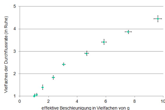
Abb. 3: Vielfaches der Ruhedurchflussrate durch die 60s-Sanduhr in Abhängigkeit von der erreichten effektiven Beschleunigung (fünf Messungen je Messpunkt)
