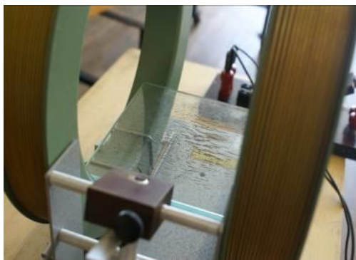
Abb. 16: Spule und Plattenkondensator haben im Inneren ein homogenes Feld. Magnetische Felder im leeren Raum sind immer geschlossen (quellenfreie Wirbelfelder).
