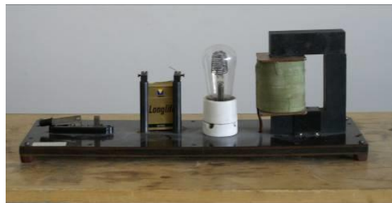
Abb. 31: Versuchsaufbau für Glimmlampe und Spule
