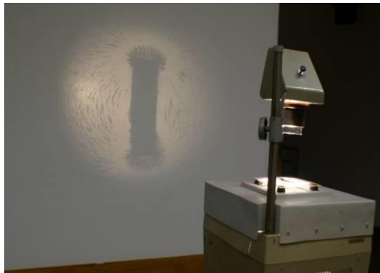
Abb. 12: Laut Feldlinienbild scheint ein magnetisches Feld \vec{H} analog dem elektrischen Feld \vec{E} zu existieren. Es ist analog dem elektrischen Feld darstellbar durch Feldlinien. Ladungen allein können dieses Feld nicht erzeugen.
