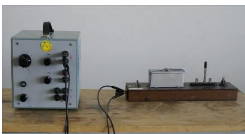
Abb. 30: Versuchsaufbau zur Kondensatorentladung
