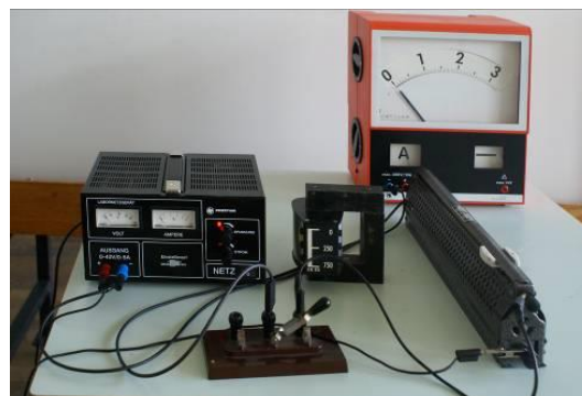
Abb. 32: Versuchsaufbau zur Demonstration des Öffnungsfunken
