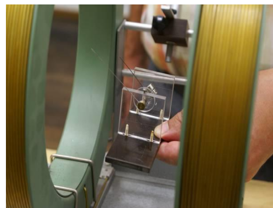
Abb. 18: Die Definition des \vec{H} -Feldes erfolgt über die Wirkung eines Drehmomentes auf einen Probemagneten \vec{M} = \vec{m} \times \vec{H} ; m wird hier in Vsm gemessen und ist betragsmäßig über das Produkt aus der Permeabilitätszahl \mu_0 , des Stromes I sowie des Betrages der vom Strom umflossenen Fläche A definiert, um die Analogie zum \vec{E} -Feld zu sichern.
