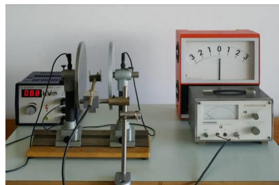
Abb. 7: Eine verschobene Ladung Q_v kann als Stromstoß \int I dt gemessen werden.
