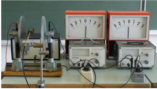
Abb. 33: Im sich ändernden elektrischen Fluss existiert ein Verschiebungsstrom, der als echter Strom messbar ist. Der gesamte Versuchsaufbau ist äußerst empfindlich und muss deshalb mit größter Sorgfalt betrieben werden.
