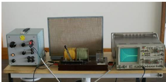
Abb. 36: Harmonische gedämpfte Schwingung in einem elektrischen Schwingkreis
