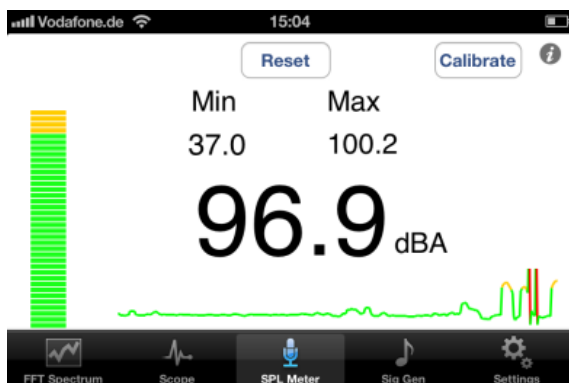
Abb. 8: Messung des Lautstärkepegels mit Audio Kit
