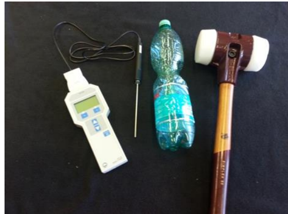
Abb. 3: Das Draufhauen auf eine leere PET-Flasche führt zu einer messbaren Temperaturerhöhung der Luft in der Flasche.
