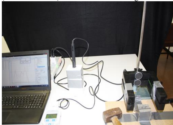
Abb. 5: Versuchsaufbau zur quantitativen Bestimmung des Wärmeäquivalents mit einem Hammer.
