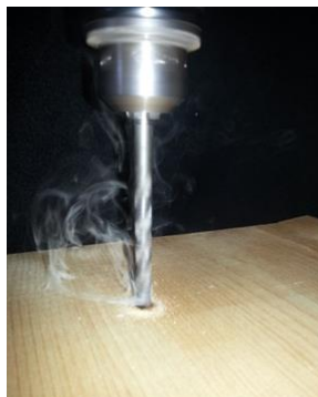
Abb. 1: Beim Bohren von Holz mit einem Steinbohrer kann man schon nach kurzer Zeit die Wärme an der Rauchentwicklung erkennen.
