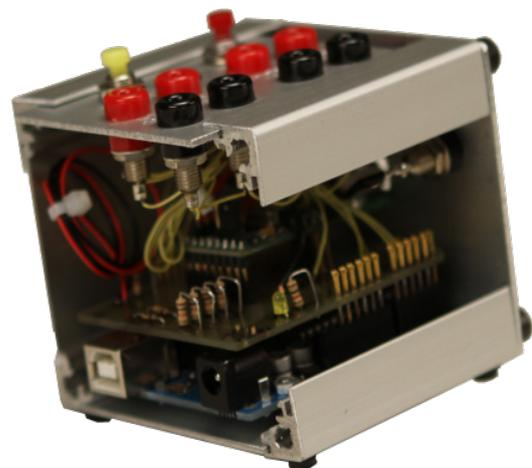
Abb. 7: *Arduino UNO* mit Stapelshield (oben) und Anschlüssen am Gehäuse (unten)
