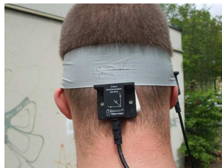
Abb. 3: Anbringung des Beschleunigungssensors im Nackenbereich.
