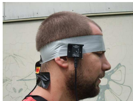
Abb. 2: Anbringung des Beschleunigungssensors im Schläfenbereich.
