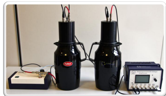
Abb.2: Ein Kamiokannenset, bestehend aus (v.l.n.r.) einer Spannungsregelung, 2 mit Wasser gefüllten Thermoskannen, auf denen Photomultiplier aufgeschraubt sind, und einer Datenauslesebox.
