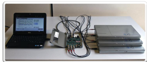
Abb.1: Das CosMO-Experimentierset. Abgebildet sind (v.r.n.l.) 3 Szintillationszählerplatten, die Datenerfassungskarte und der Computer zur Analyse der Daten.
