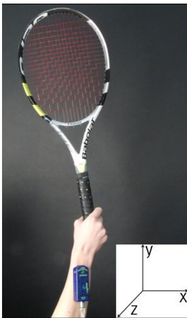
Abb. 17: Versuchsaufbau – Positionierung des Beschleunigungssensors
