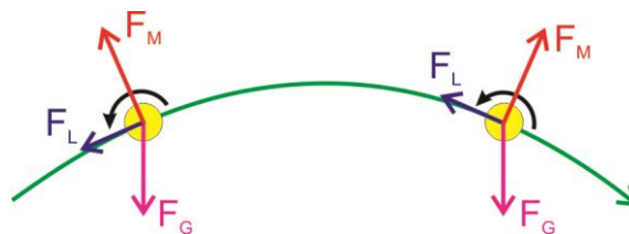
Abb. 22: Kräfte, die auf einen mit Rückwärtsdrall (Slice) geschlagenen Tennisball wirken
