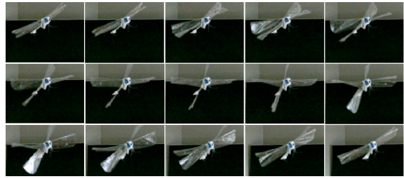
Abb. 8: Standbildserie einer fliegenden Kunstlibelle (Fotos: L. Kasper, Aufnahme mit 240 fps)
