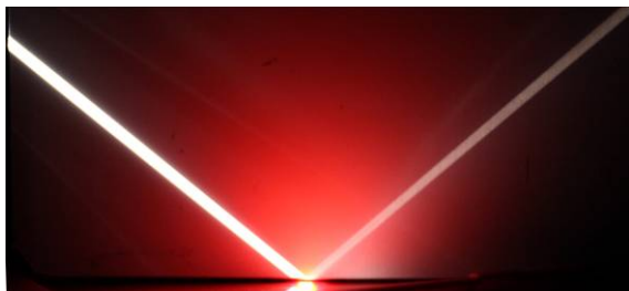
Abb.4: Gerichtete und diffuse Reflexion eines weißen Lichtbündels, beim Auftreffen auf einen roten Kunststoff.
