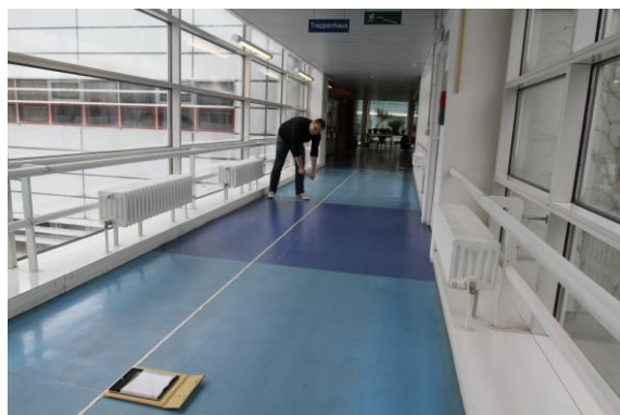
Abb. 2: Durchführung der Messung zur Bestimmung der Schallgeschwindigkeit
