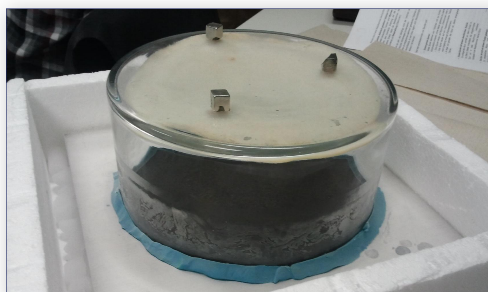
Abb. 2 In dieser einfachen Nebelkammer können Elementarteilchen sichtbar gemacht werden.
