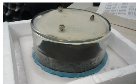
Abb.3: So kann die selbst gebaute Nebelkammer aussehen.
