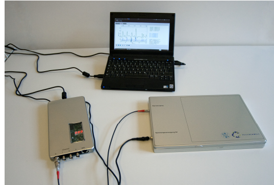
Abb.2: Das Szintillationszähler-Experiment. Auf dem Bild ist nur ein Szintillationszähler (rechts im Bild) angeschlossen. Bis zu drei können an die DAQ-Karte (links im Bild) angeschlossen werden.
