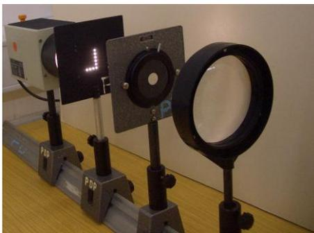
**Abb. 6:** Demonstrationsversuch zur Verdeutlichung des Zusammenhanges zwischen Blende und Schärfentiefe [6]
