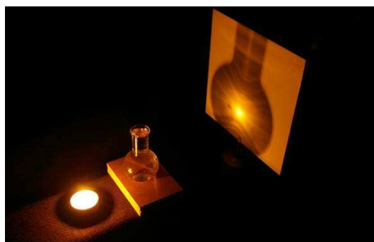
Abb. 7: Lichtbündelung durch eine Schusterkugel.
