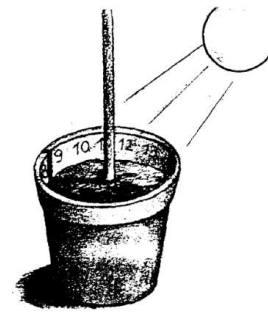
Abb. 9: „Blumentopfsonnenuhr“ als Beispiel für eine Sonnenuhr mit „senkrechtem Schattenstab“. (nach [1], S. 10)
