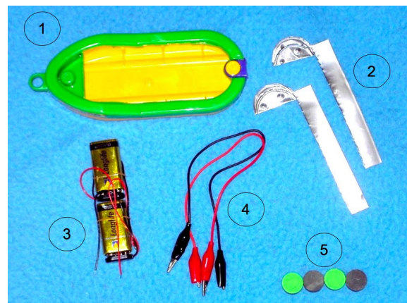
Abb. 3: Die Baumaterialien: 1 Spielzeugschiffchen, 2 aufgeschnittene Teelichtdosen, 3 Batterien mit Anschlüssen (2 x 9V-Block in Reihe), 4 Verbindungskabel, 5 Magnete (Südpol markiert)
