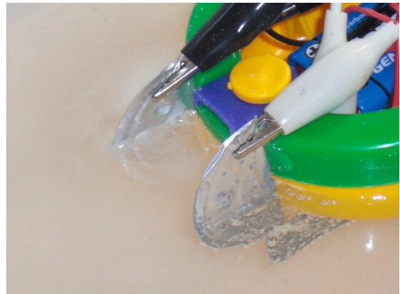
Abb. 5: Gasentwicklung an den Elektroden
