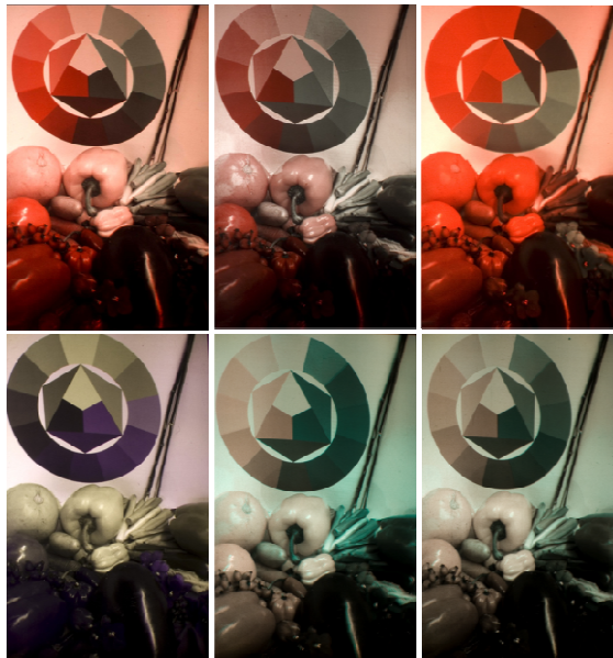
Abb. 7: Diaprojektion des Landeffekts unter Verwendung der Kombination von: Rot- und Grün-; Rot- und Cyan-; Rot- und Blauauszug; (obere Zeile von links); Magenta- und Grün-; Cyan- und Rot-; Cyan- und Gelbauszug (untere Zeile Anordnung links beginnend). Bei all diesen Projektionen wurde vor dem als erstes genannten Farbauszug, der zur Herstellung des Farbauszuges benutzte Filter als Projektionsfilter verwendet (Bsp. Cyan- und Rot-; Cyanauszug wurde mit davor positioniertem Cyanfilter von der Projektion des Rotauszuges mit weißem Licht überlagert).
