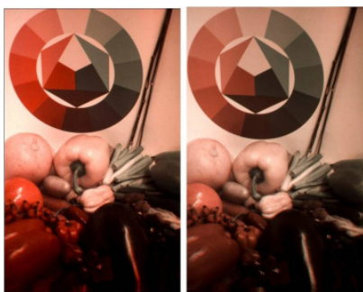
Abb. 8: Vergleich Diaprojektion mit rotem Bandpass- und rotem Roscofilter.
