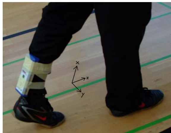
Abb. 4: Befestigung des Sensors am Unterschenkel beim Gehen und Koordinatenachsen des Sensors
