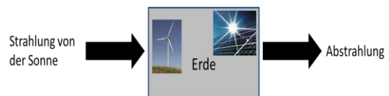
Abb.4: Bei der Sonnenenergie herrscht ein Fließgleichgewicht zwischen Zustrom und Abstrom. Durch z.B. Wind- und Solarenergie zapfen wir diese Energiequelle nur an. Hier ist die Flussdichte entscheidend.
