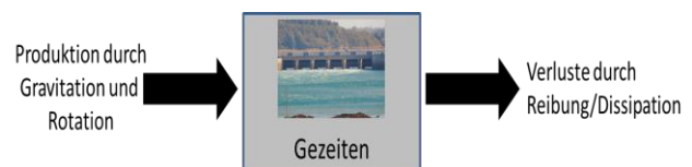
Abb. 5: Bei der Gezeitenenergie herrscht ein Fließgleichgewicht zwischen Zustrom und Abstrom. Die Gezeitenkraftwerke haben einen vernachlässigbaren Einfluss auf den Reibungsverlust und durch sie „zapfen“ wir die Energie nur an. Hier ist die Flussdichte entscheidend.
