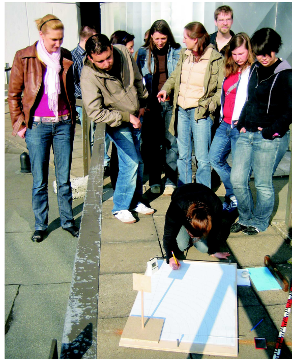
Abb 11: Die Markierung der Schattenspitze im Rahmen einer astronomischen Veranstaltung an der Universität in Essen. Als Spitze des Schatten„stabes“ wurde ein kleines Loch verwendet. Die Mitte des von ihm auf der horizontalen Fläche erzeugten Sontentalers lässt sich sehr genau markieren. Die Projektzeitpunkte wurden so gewählt, dass die Sonne gerade senkrecht über Bangalore in Indien, Bridgetown auf Barbados bzw. exakt südlich von Hawaii stand. Das war deshalb wichtig, weil die jeweilige Entfernung zum subsolaren Punkt es den Teilnehmern ermöglichte, allein mit der eigenen
